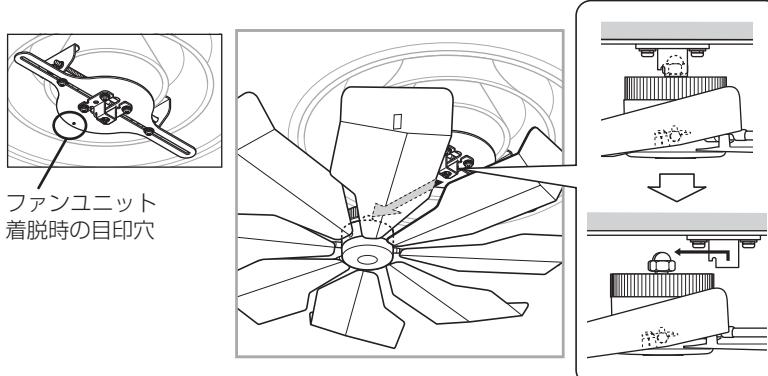
**重要:** ● 取り外したファンは必ず水平に置いてください。壁等への立て掛けは、羽根やシャフトが破損する原因となることがあります。
