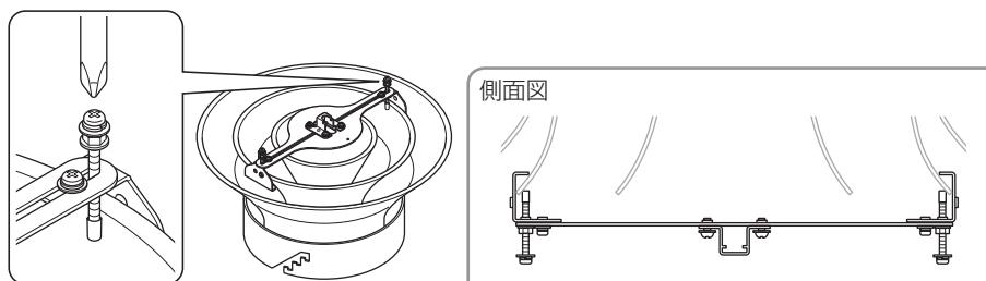
**参考:** 小型用取付金具をコーンから取り外すときは、はじめにフランジ付6角ナットをゆるめます。
