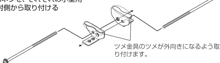
4. 小型用取付金具をM4ネジ（2本）で取り付ける
