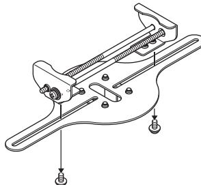
2. 台座を固定しているM4ネジ（4本）を外し、台座をプレートから外す
